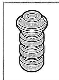
La butée d'attaque demeure d'origine en version Terre et devra être recoupée en version Asphalte.
